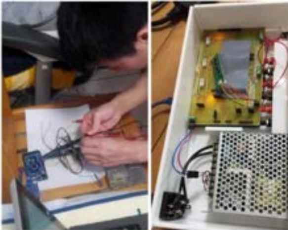
▲研究團隊不斷再進化，把初的線路與配電方式相當簡陋（如左圖），為了減少組裝時間，進而梳理出一個完整的配電盒誕生（如右圖）。（照片拍攝/廖元鈞）
