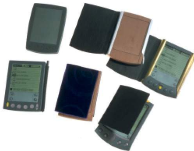
Exhibit 15 : Palm V : 外蓋及觸控筆配置之設計原型
