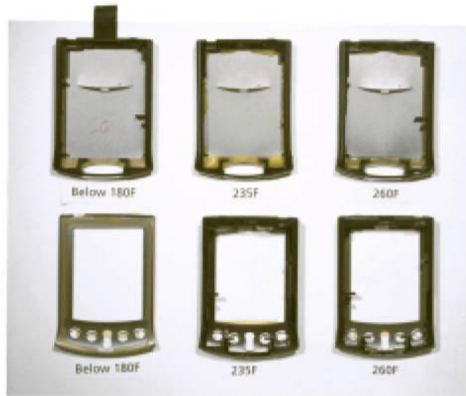
Exhibit 17 : Palm V : 在不同溫度下，測試接著劑的最佳化
